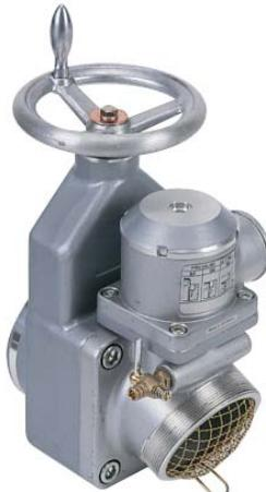
Válvula Gaveta Especial Modelo 6502 para abertura e fechamento de sistemas de grande vazão, fabricada em liga leve de alumínio, com cotovelo de 25º, haste não ascendente, dotada de válvula ventosa, filtro e válvula de alívio para garantir operação segura. Volante com empunhadura, necessitando aproximadamente 8 voltas para abertura e fechamento total.
