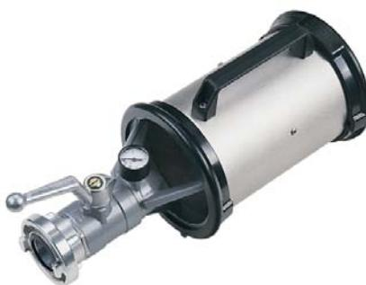
Esguicho de Média Expansão Modelo 3701M, conexão tipo engate rápido, dotado de válvula esfera e manômetro, tubo em aço inoxidável, anel de proteção em borracha e empunhadura plástica.
