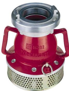
Ralo de sucção, conexão tipo engate rápido, com válvula de retenção para prevenir a ausência de coluna de água, quando o processo de sucção é interrompido. Dotado de dreno e alça opcional.
